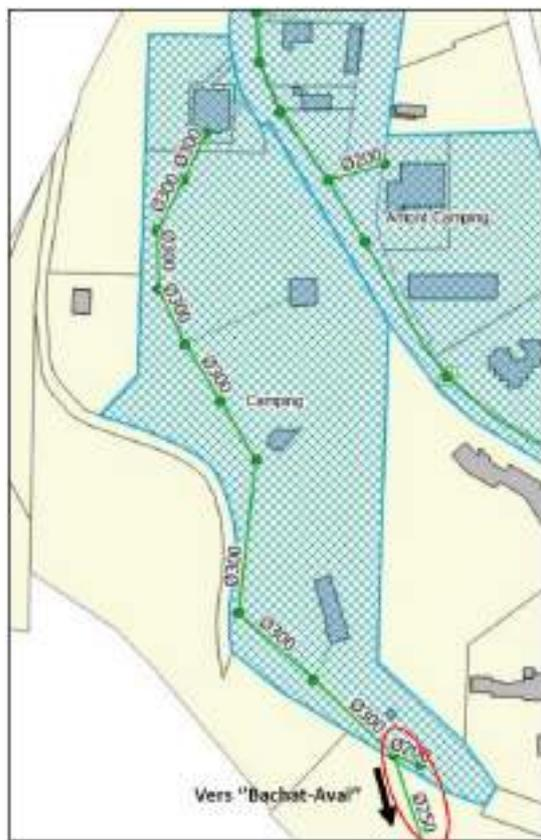
Ce bassin de collecte récupère une partie des eaux de ruissellement et de toiture du camping « Les Chalets des Cimes » avec des collecteurs Ø 300. Il achemine les eaux vers le bassin de collecte « Bachat-Aval » via un collecteur Ø 250.
