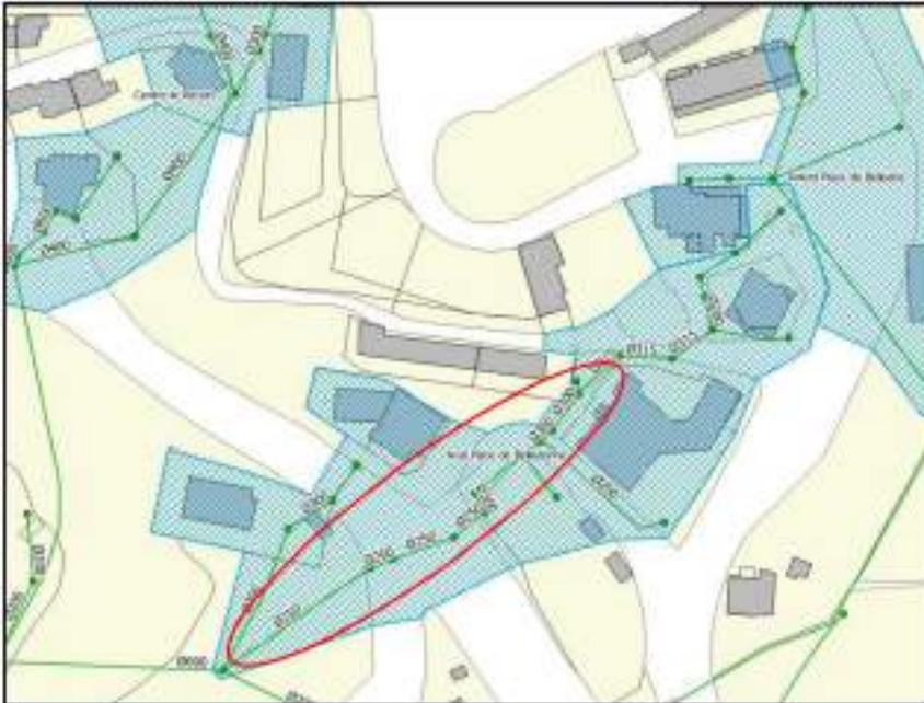
Ce bassin de collecte récupère une partie des eaux de voirie et de toiture depuis la Place de Belledonne jusqu'à l'amont du bassin de la Grenouillère. Il est constitué de collecteurs Ø 200 à Ø 315.
